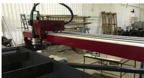
Установлены мощные двигатели с планетарными редукторами и механизмом компенсации люфтов в зубчато-реечной передаче. Все это повышает точность, динамичность работы оборудования и уменьшает время на обслуживание приводов. См фото.
