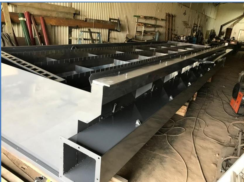
Стол обшит со всех сторон. Имеются специальные люки. В зависимости от комплектации станка подготовка к вентиляции либо отсутствует (бюджетный вариант) или выполнена система вытяжки в зоне реза, что многократно повышает производительность вытяжки. При обустройстве системы вентиляции оборудование должно иметь производительность не менее 6000 м.куб./час.
