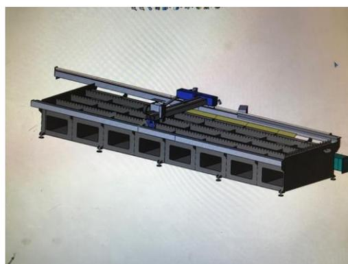
Рабочий стол сухого типа, интегрированный в конструкцию машины. Ширина раскроечного стола 2100 мм, длина стола 6150 мм.
